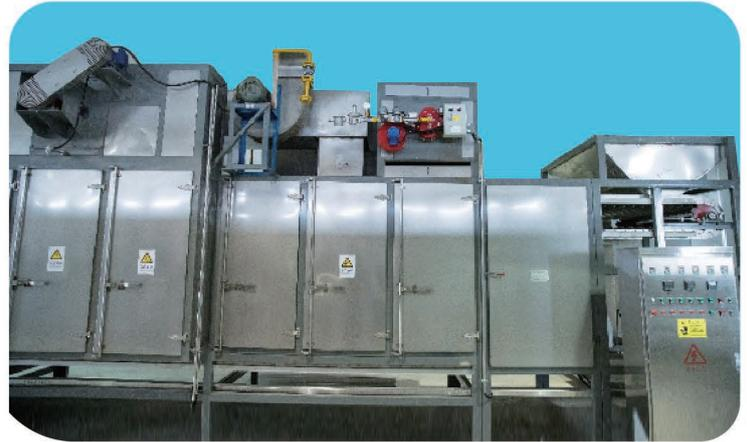
单/三/五层坚果杀青、预烘、烘干自动生产线。采用左右进风, 上下均风, 无死角, 温度可调范围大和远程控制的特点 适合各类瓜子以及壳坚果和树坚果的预烘与烘干。
