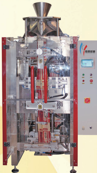
HKD-II型水平给袋式自动包装机 HKD-II TYPE AUTOMATIC HORIZONTAL PACKING MACHINE
