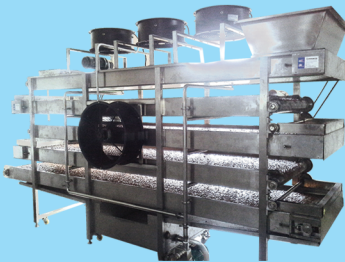
Multi layer fan cooler
