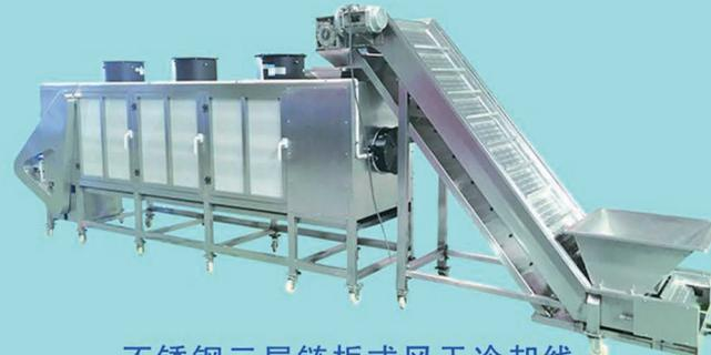
不锈钢三层链板式风干冷却线
